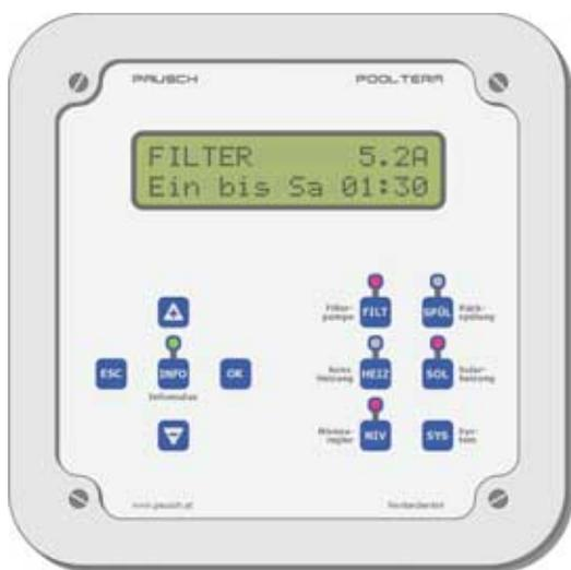
Mit diesem formschönen **Unterputz** – Fernbedienteil können die Schwimmbadsteuerungen **ALLPOOL**, **PSM03all** und **PSM04all** bequem z.B. von der Schwimmhalle oder Wohnzimmer aus bedient werden, auch wenn die Poolsteuerung unzugänglich im Technikraum montiert ist.
