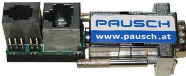
Interface & Kabel, um das GSM-Modem TC35 mit unseren [Fernwirkgeräten](#) TELCONvoice und TELCONeasy zu verbinden, um diese Geräte ohne Festnetz zu betreiben.
