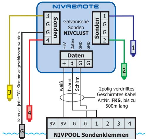
tungen (Sondenzustände, Empfindlichkeit, Checksumme) sondern auch die Stromversorgung. Mit unserem FKS-Kabel ist eine völlig störstichere Datenübertragung sichergestellt.
