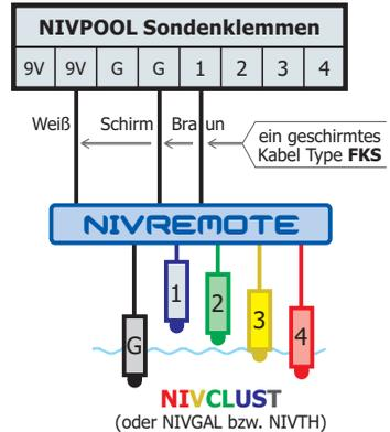
Die Verbindung zum NIVPOOL erfolgt über ein einziges geschirmtes zweipoliges Kabel mit der Artikel Nr. FKS. Entfernungen von 500m sind problemlos möglich. Über dieses Kabel erfolgt nicht nur die Datenübertragung in beide Richtungen.
